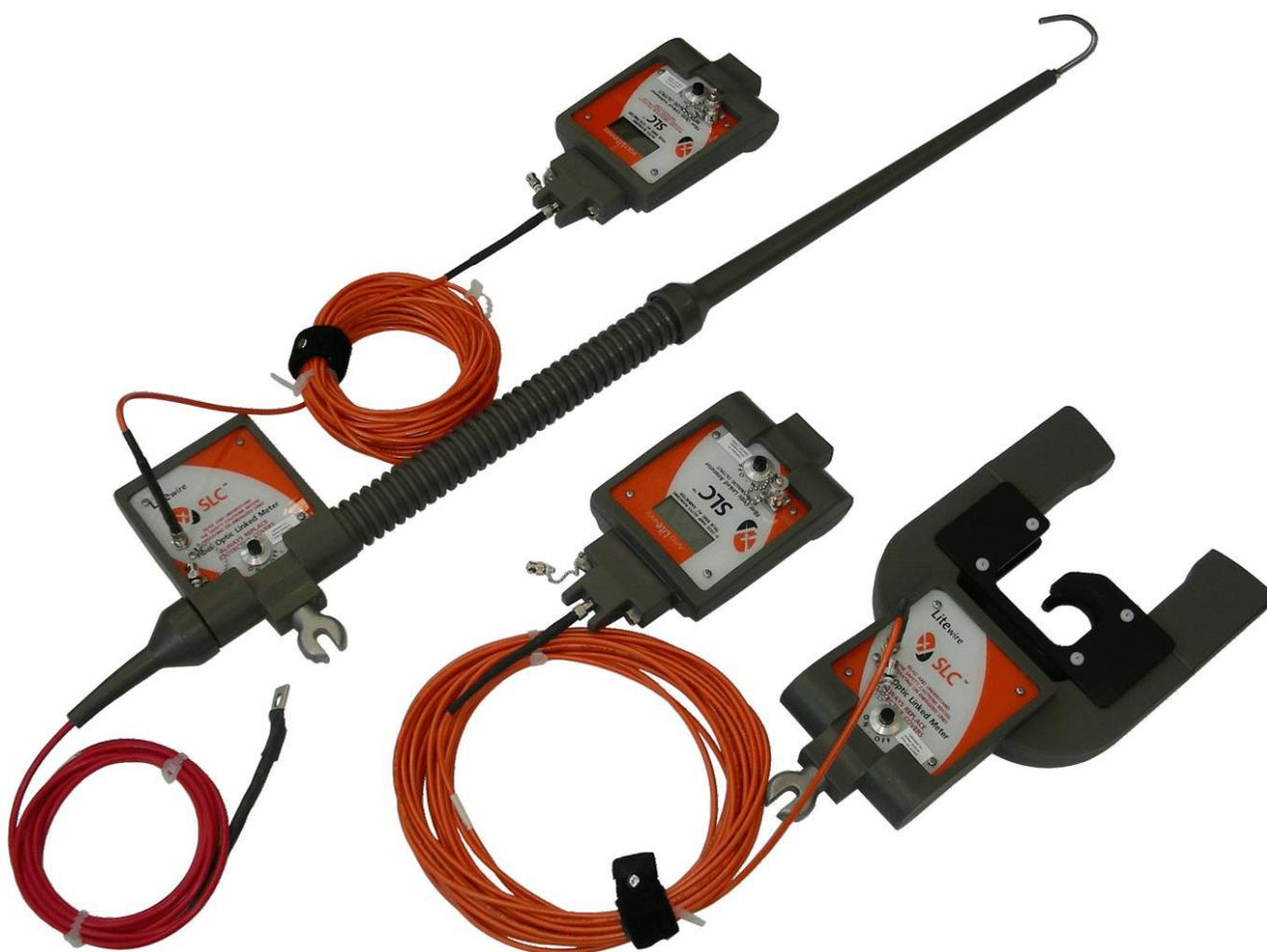
Die LiteWire Sensoren können für die MTE-Zählerprüfgeräte PRS 400.3, CALPORT 300, PWS 3.3, PWS 2.3 PLUS und PTT 2.1 verwendet werden. Der LiteWire Sensor ist ein Effektivwert-Messgerät, welches für Überprüfungen der Kurvenformen von Strom und Spannung auf der Primärseite von Messwandler in Hochspannungsnetzen entwickelt wurde. Eine Lichtwellenleiterverbindung dient sowohl zur Datenübermittlung als auch zur Isolierung der am Sensor anliegenden Hochspannung.
